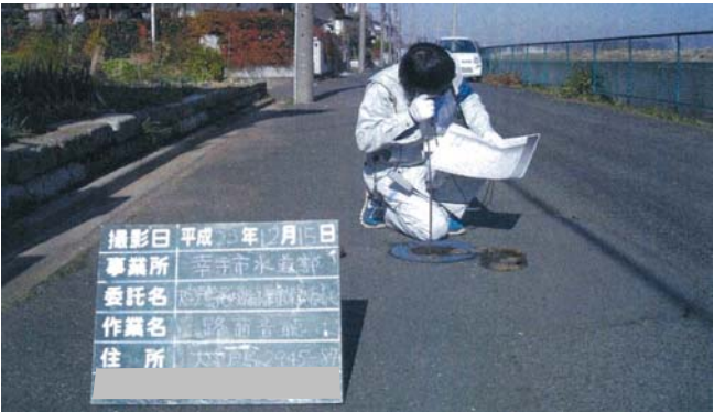
図 6-10 漏水調査の実施状況
